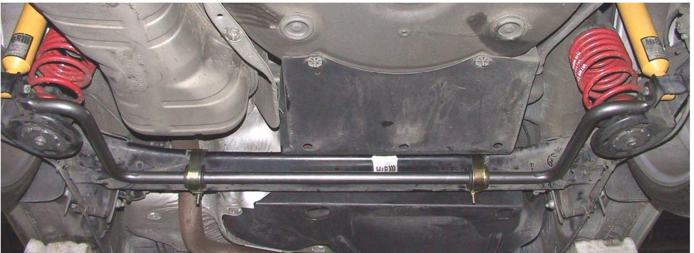
Abbildung/figure 3: Eingebauter HA-Stabilisator/fitted rear axle swaybar
