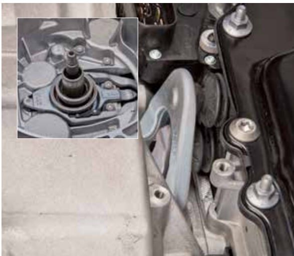
Gegossene Einrückhebel – Getriebe-Baudatum bis Mai 2011, Generation 1
