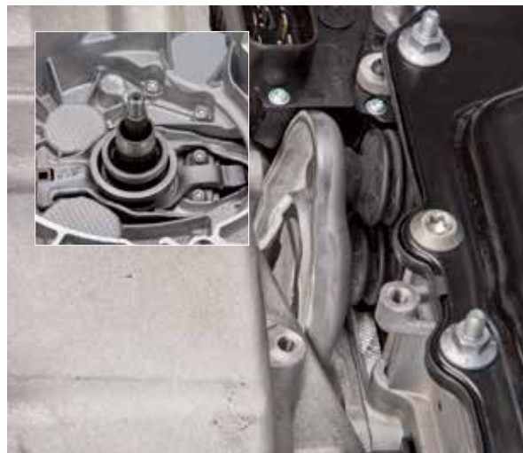
Einrückhebel aus Stahlblech – Getriebe-Baudatum ab Juni 2011, Generation 2
