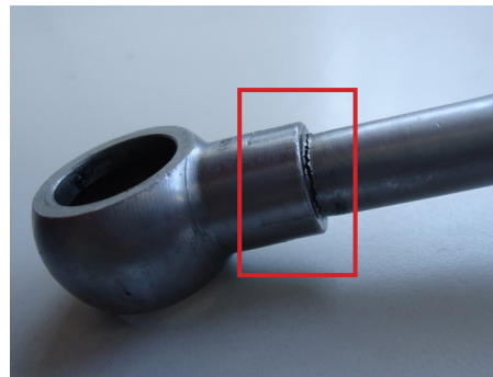
Ejemplo de rotura por fatiga en la zona de unión banjo-tubo
