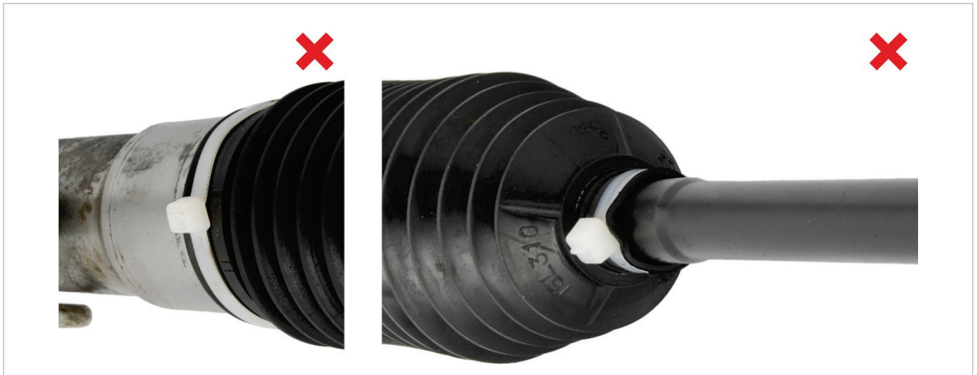
Abb. 8: Bypass: Mangelhafte Abdichtung mit Kabelbindern
