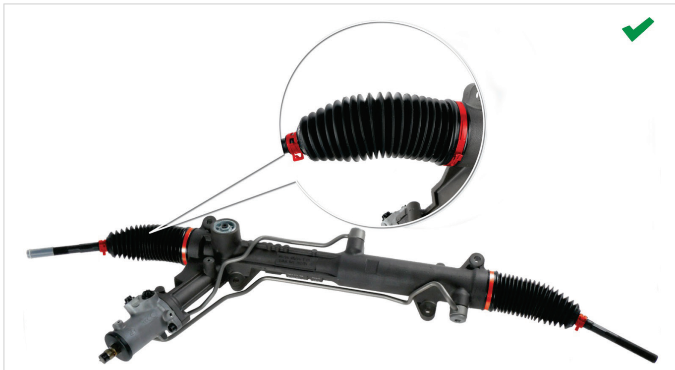
Abb. 2: Lenktriebe mit hydraulischer Lenkkraftunterstützung: korrekt montierte Lenkmanschetten
