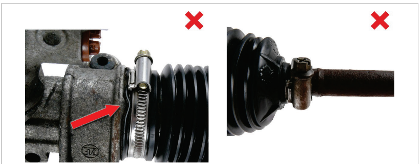
Abb. 7: Bypass: Mangelhafte Abdichtung mit Schlauchschellen
