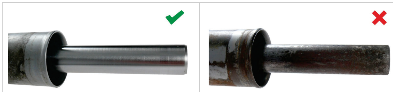
Abb. 3: Zahnstange ohne Korrosion
