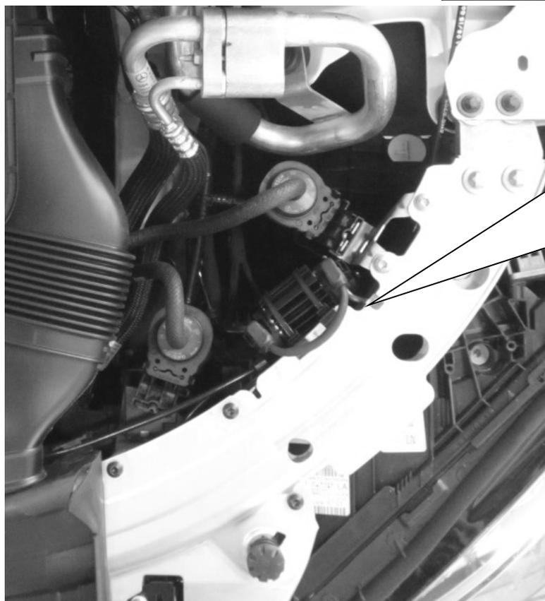
Originale Dämpfersteuerungsleitung in das Elektronikbauteil einstecken. Auf die korrekte Verriegelung des Steckers achten! Anschließend originale Dämpfersteuerungsleitung mit Kabelbinder am Kabelbaum befestigen. Darauf achten dass die Leitung nirgends scheuert.
