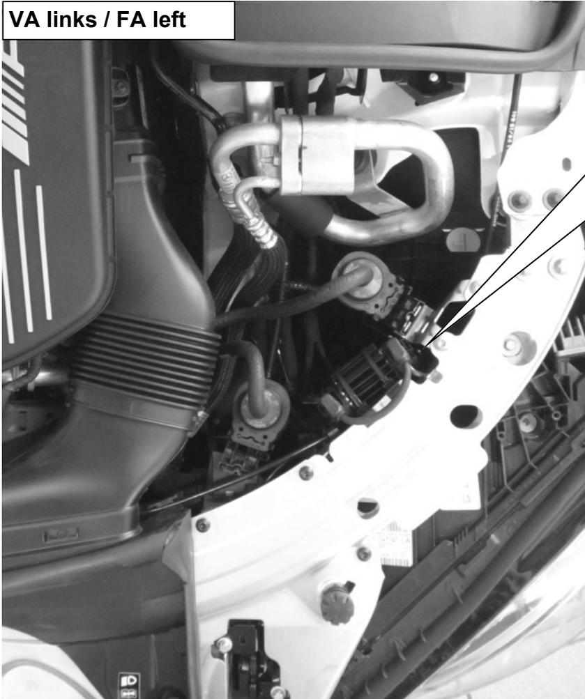
Elektronikbauteil mit den Edge Clips an der Karosseriekante befestigen.
