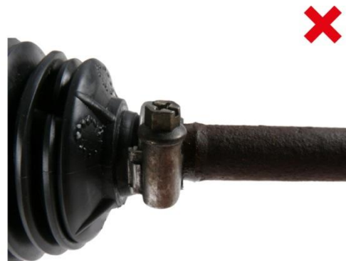
Abb./Fig. 5: Kein Bypass: korrekte Abdichtung mit Metallschellen / No bypass: Correct seal with metal clamps / Aucun by-pass : étanchéité correcte avec colliers en métal / Sin derivación: estanqueización correcta con abrazaderas de metal
