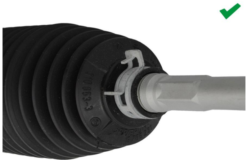
Abb./Fig. 5: Kein Bypass: korrekte Abdichtung mit Metallschellen / No bypass: Correct seal with metal clamps / Aucun by-pass : étanchéité correcte avec colliers en métal / Sin derivación: estanqueización correcta con abrazaderas de metal
