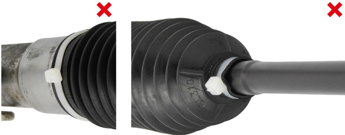
Abb./Fig. 7: Bypass: Mangelhafte Abdichtung mit Kabelbindern / Bypass: Defective seal with cable ties / By-pass : étanchéité défectueuse avec attache-câbles / Derivación: estanqueización deficiente con sujetacables
