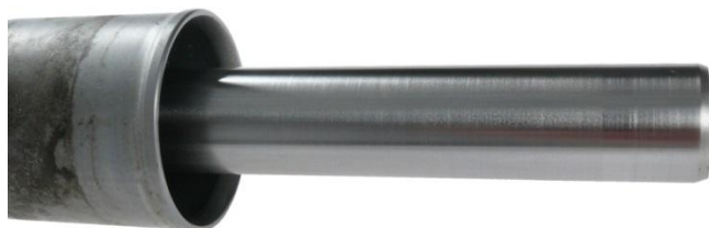
Abb./Fig. 2: Zahnstange ohne Korrosion / Steering rack without corrosion / Crémaillère sans corrosion / Cremallera sin corrosión
