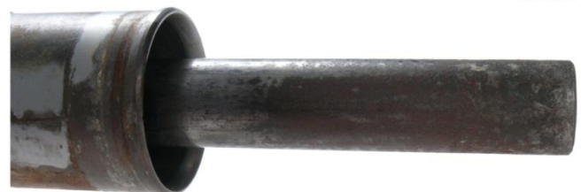
Abb./Fig. 3: Zahnstange mit Korrosion / Steering rack with corrosion / Crémaillère avec corrosion / Cremallera con corrosión
