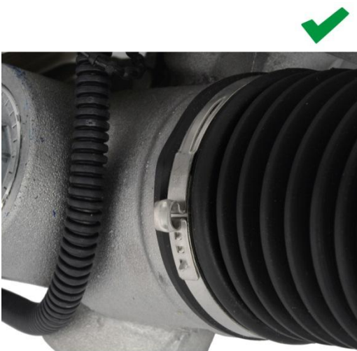
Abb./Fig. 5: Kein Bypass: korrekte Abdichtung mit Metallschellen / No bypass: Correct seal with metal clamps / Aucun by-pass : étanchéité correcte avec colliers en métal / Sin derivación: estanqueización correcta con abrazaderas de metal
