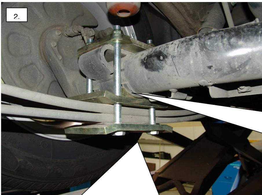
Bei der Montage der Grundplatten ist darauf zu achten, dass die Führungen mittig der Achsen sind.
