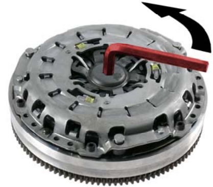
Fig. 3: Verriegelungsstück herausdrehen / Unscrew locking piece / Retirer la pièce de verrouillage en tournant / Desenroscar la pieza de enclavamiento / Rimozione dell'elemento di bloccaggio
