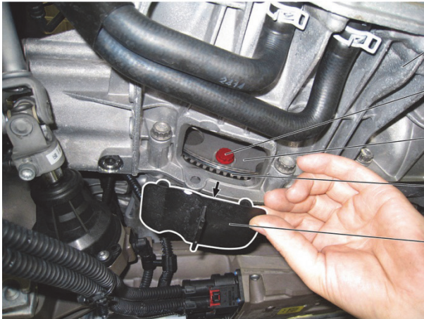
Abb./Fig 1: Abdeckung (5) demontieren / Remove cover (5) / Démontér le couvercle (5) / Desmontaje de la cubierta (5)
