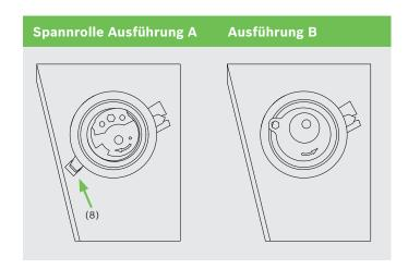
Beide Spannrollen werden nach Vorgabe in ESI[tronic]-M montiert. Für die Montage der neuen Spannrolle (3) unbedingt darauf achten, dass der Stehbolzen vollständig in das Motorgehäuse eingeschraubt ist, damit die Grundplatte der Spannrolle lastfrei aufliegt.
