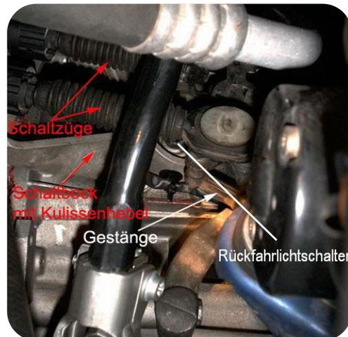
**Wichtig:** Um diese aufwändigen Folgeschäden zu vermeiden unbedingt während der kompletten Montage den **Rückwärtsgang eingelegt lassen!**
