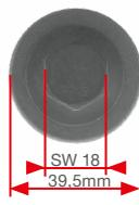
**TR** Montajdan önce, motora monte edilen krämkömli civatası, aşağıda gösterilen civatalarla mutlaka karşılaştırılmalıdır ve her durumda üreticinin belirttiği tork değerlerinde sıkılmalıdır. Bu civatalar tamir işleminde tekrar kullanılmamalıdır.
