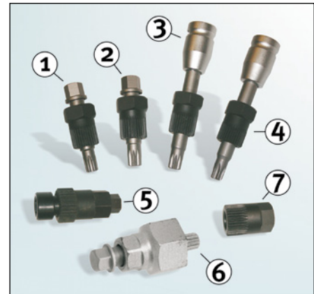
Bild 5: Erforderliches Spezialwerkzeug zum Aus- und Einbau verschiedener Freilaufriemenscheiben
