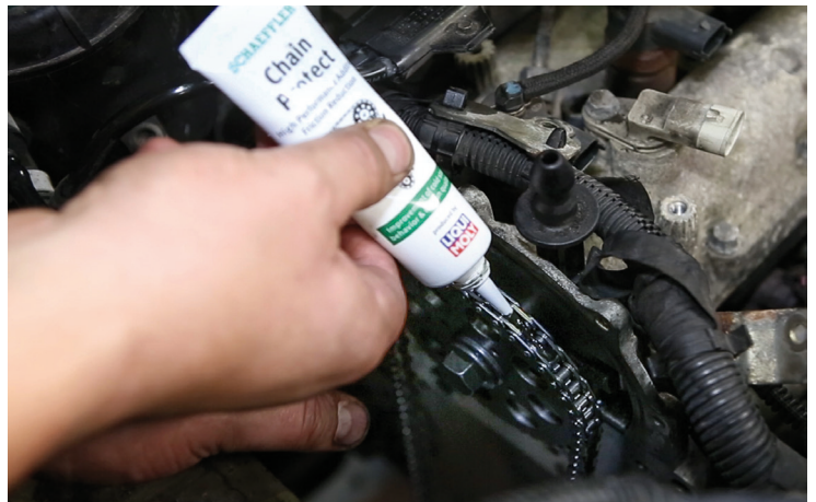
Bild 2: Schaeffler Chain Protect wird während der Ketten-Montage auf alle Komponenten im Steuertrieb aufgetragen.
