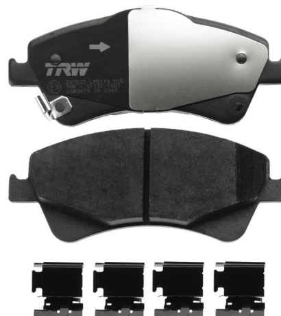
GDB3479 mit mechanischer Verschleißanzeige, Regennut, Shim (Metall und Kunststoff), Pfeil und einzelnen Belagführungsblechen.
