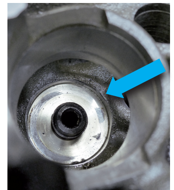
Abbildung 3: Druckspuren im Zylinderkopf
