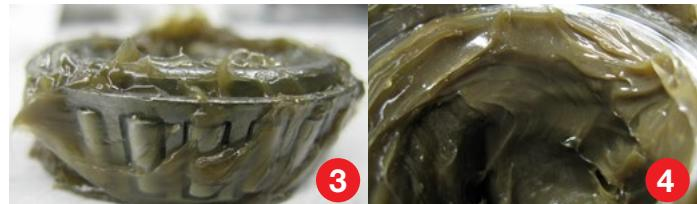
**(DE)** Bei der Montage dieser Radnabe auf den Achsschenkelzapfen wird das in die Radnabe eingefüllte Fett (1) herausgedrückt. Das äußere Kegelrollenlager (2) und die Lagerschale müssen vor der Montage des Lagers mit dem ausgedrückten Fett großzügig gefettet werden (3 und 4).
