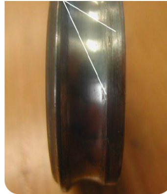
Beschädigungen außerhalb der Kugellaufbahn
