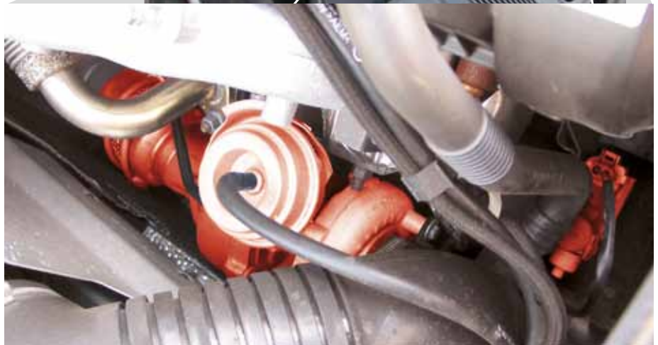
EPW und VTG-Lader (rot hervorgehoben) im Audi A4 TDI
