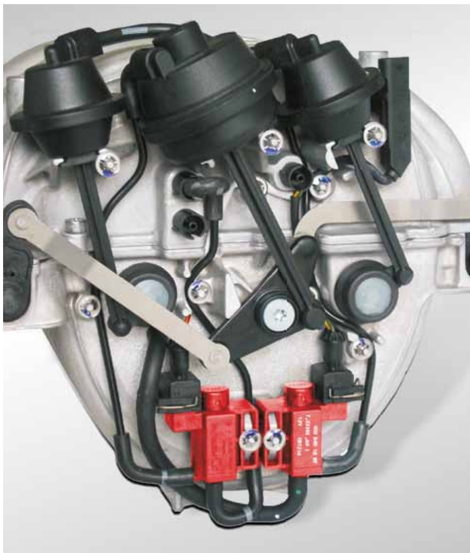
Anwendungsbeispiel: Saugrohr mit elektropneumatischen Ventilen (rot hervorgehoben) in der Mercedes C-Klasse
