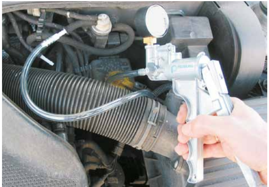
Prüfung eines EPW mit der Hand-Unterdruckpumpe (VW Golf IV)
