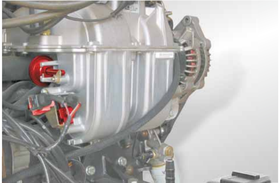
Am Schaltsaugrohr im Opel Astra sind gleich zwei EUV angebracht (rot hervorgehoben). Eines steuert über die darüber liegende Druckdose (rot hervorgehoben) die Saugrohrklappen; das andere schaltet das Sekundärluft-Abschaltventil (nicht abgebildet).
