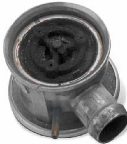
Schaden durch Abgaskondensat
