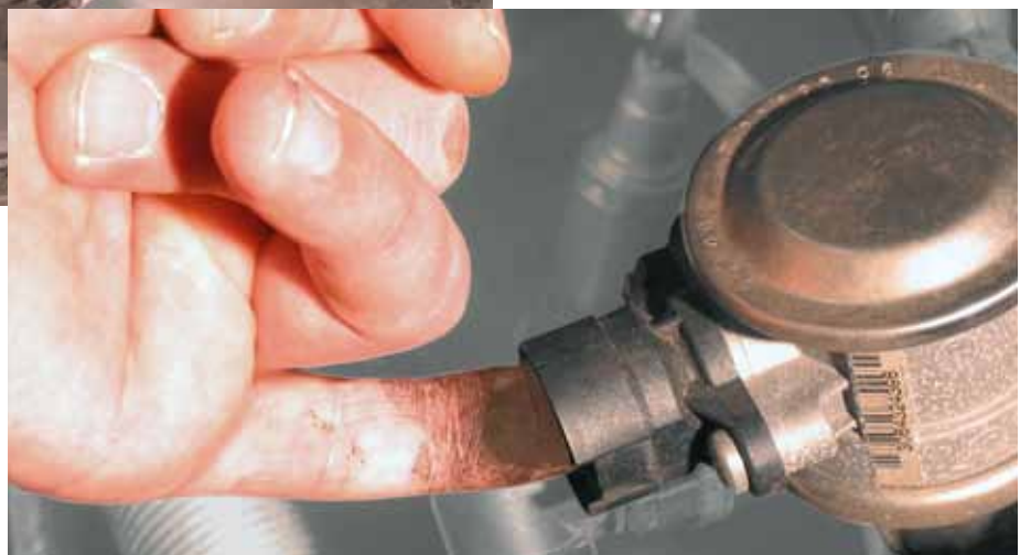
Schnellprüfung am Sekundärluftventil im BMW 520i (hervorgehoben)
