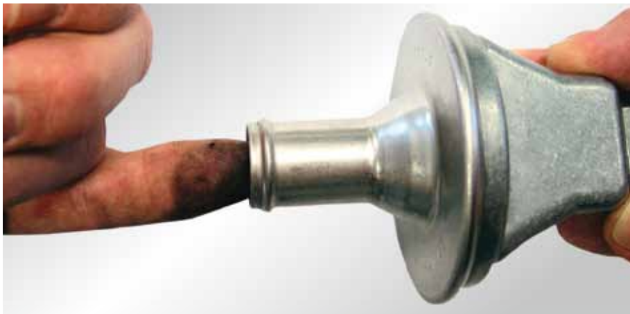
Einfache Prüfung des Rückschlagventils
