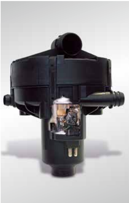
Blick in die Sekundärluftpumpe (geschnitten) mit Schmelzspuren
