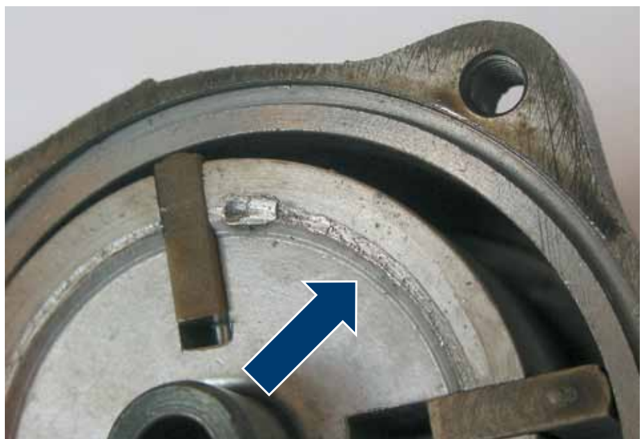
Diese Flügelzellenpumpe hat durch Ölmangel "gefressen"
