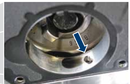
Beispiel: Beim Opel Vectra erfolgt die Schmierölaufuhr durch Bohrungen im Flansch
