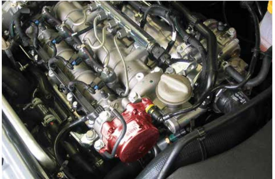
Vakuumpumpe im Opel Vectra B (hervorgehoben)
