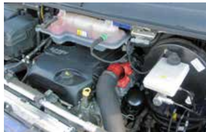
Regelklappe (rot hervorgehoben) im Motorraum eines Iveco Daily 3.0 l
