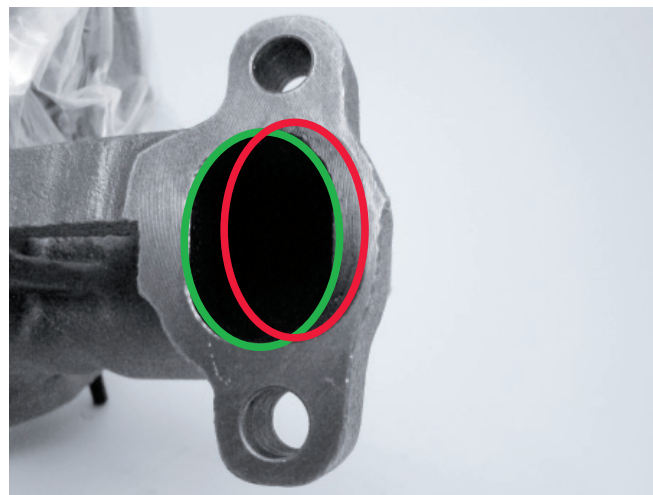
Ilustracja 2: Przykład 030TC15116000: czerwona elipsa: nieprawidłowa pozycja, zielona elipsa: prawidłowa pozycja
