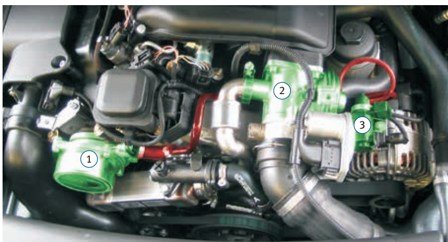
Beispiel BMW 118d (E87), (grün hervorgehoben: Bauteile im Unterdrucksystem, rot hervorgehoben: Unterdruckschläuche)
