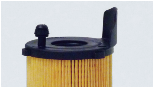
Photo 3 : Modèle avec guide : cette copie ne viole certes pas le brevet MAHLE mais risque fort d'endommager le clapet de dérivation du moteur !
